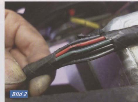
fälligen Lichtmaschinen Regler, auch Rectifier genannt. Dieser ist bei allen 3W der ersten Serie vorn links am Motor befestigt. Die Befestigung am Motor bewirkt jedoch erhebliche Belastungen der Kabel, der V-Twin bewegt sich doch ganz schön, was sehr häufig zu ab vibrierten Kabeln führt.
