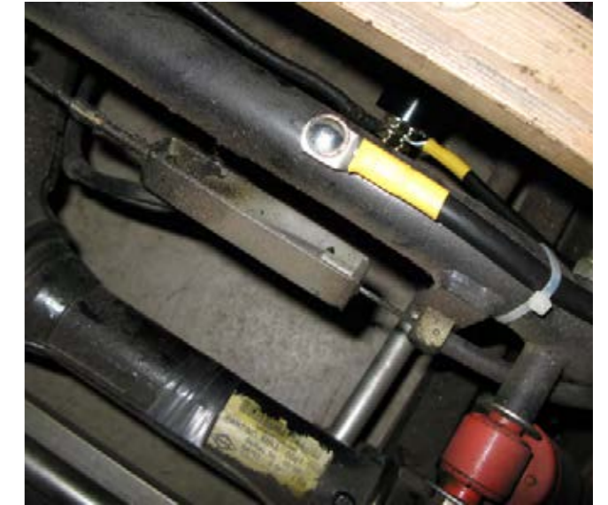
Massekabel am Querholm verschraubt
